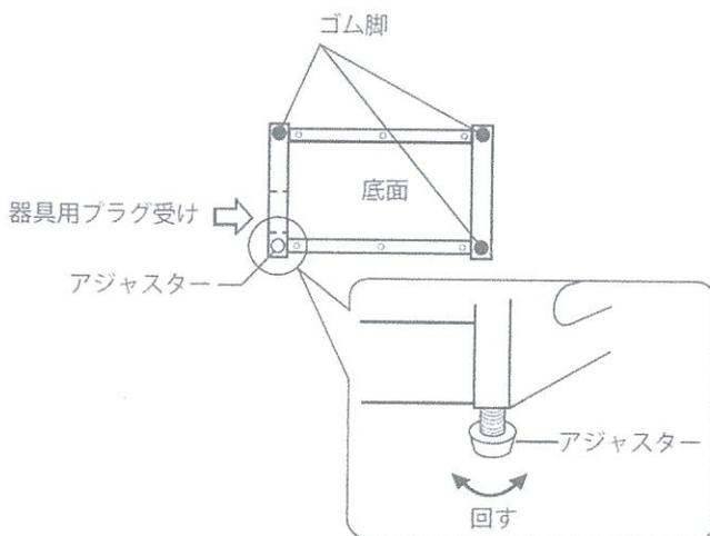
アジャスターを回して高さを調節し、床に置いたときにがたつきのないように調節する。
